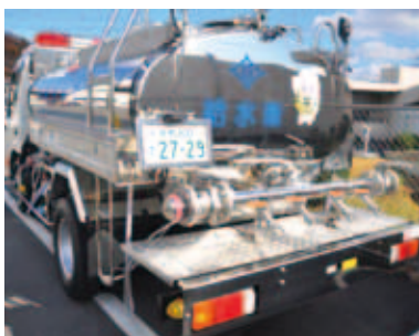
加圧式給水車の導入
