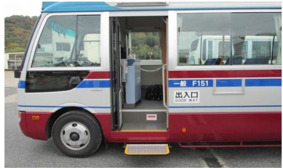
図表 26 電動ステップ付きのバス車両(北振バス)
